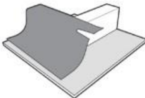
4) Mise en place et soudage du deuxième coté
